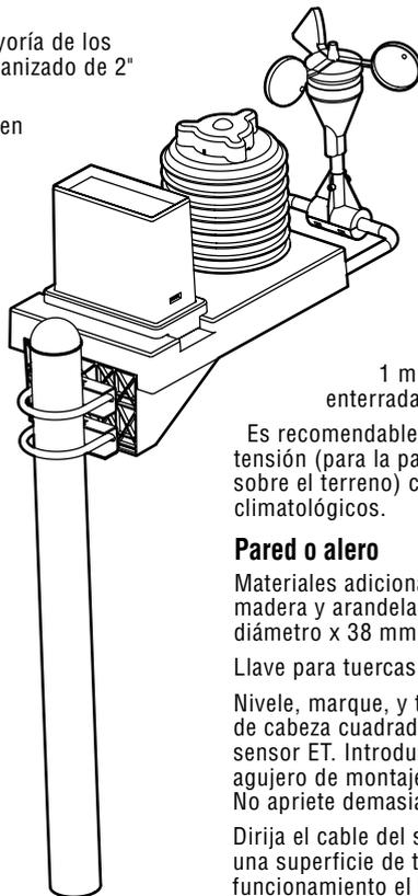
Haga un agujero de aproximadamente 30,5 x 30,5 (o mayor, según lo dicte la normativa local) y llénelo con una bolsa de hormigón de aproximadamente 40 kg. Introduzca el poste, compruebe con un nivel y enderécelo; sujete hasta que el hormigón esté firme.
