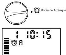
**NOTA:** Un arranque activará automáticamente todas las estaciones secuencialmente en el programa. Esto elimina la necesidad de programar el arranque de cada estación individualmente. Se pueden usar arranques de ciclo múltiples en un programa para separar los ciclos de riego de la mañana, la tarde o la noche. Se pueden introducir los tiempos de arranque en cualquier orden. El XC los ordenará automáticamente.
